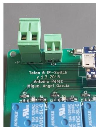
**Fig. 8. Entrada Aux. Talon6 IP\_Switch**
