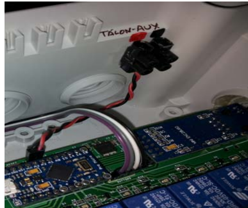
Fig. 8. Entrada Aux. Talon6 IP_Switch
